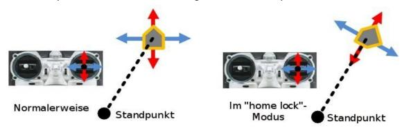
Für die Nutzung der Funktion muß senderseitig ein 2- oder 3-stufiger IOC-Schalter festgelegt werden. Der entsprechende Kanal-Ausgang des Empfängers wird mit dem X2-Eingang des MC-Moduls verbunden. Den Feinabgleich führt man am Sender so durch, daß die einzelnen Schalterstellungen in den korresponierenden Modi Home lock, Course lock oder OFF zu liegen kommen (Schieber im Programm verfärbt sich an diesen Stellen blau).
