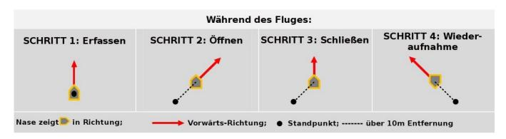
**SCHRITT 1: Erfassen des Standpunktes** Der oben aufgeführte "Standpunkt" entspricht dabei der Position, die auch für das erweiterte Falisafe-Verfahren (automatische Rückkehr und Landung) zur Anwendung kommt. Im Normalfall handelt es hierbei um die Startposition. Es gibt hier zwei Möglichkeiten zur Erfassung: Manuell oder automatisch:
