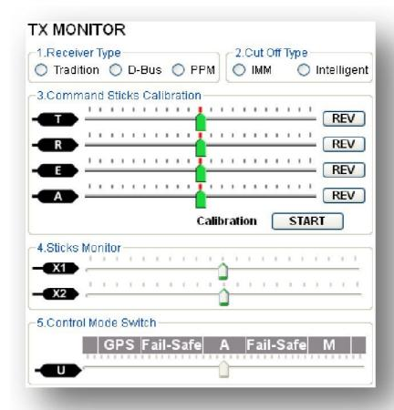
Hinweis: Vor diesem Schritt sollten aus Sicherheitsgründen alle Propeller demontiert werden!
