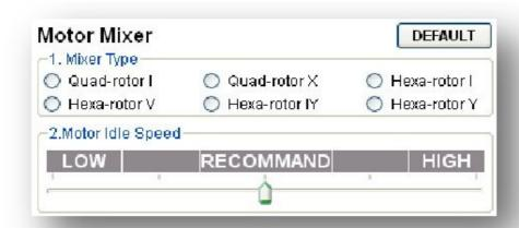
Am RC-Sender ist der 3D-Modus (Acrobatic) zu aktvieren. Danach wählt man die zum Multikopter passende Einstellung unter "Motor-Mixers".
