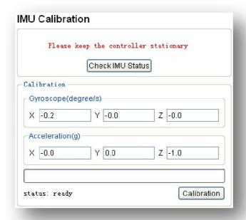
Die IMU-Kalibrierung kommt dann zur Anwendung, wenn das Modell im Schwebeflug abdriftet oder sich zu drehen beginnt. Durch den Abgleich der Kreiselsensoren lassen sich dann bessere Flugergebnisse erzielen. Die Überprüfung führt man nun durch, wenn in der Oberfläche der Status "ready" angezeigt wird. Je nach Ergebnis, sind daraufhin weitere Schritte nötig.
